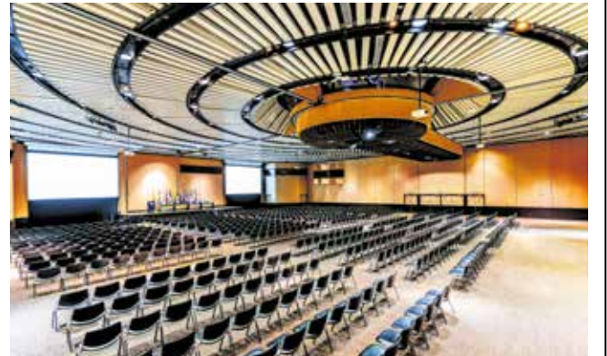
GRAN SALÓN BARAHONA. Con nuevo cielo raso metálico provisto de aislamiento acústico, se actualizó el sistema de paneles móviles y muros perimetrales, alfombra, puertas anti pánico y luces LED. Se modernizaron proyectores a tipo cine y potencializó el sistema de audio.
