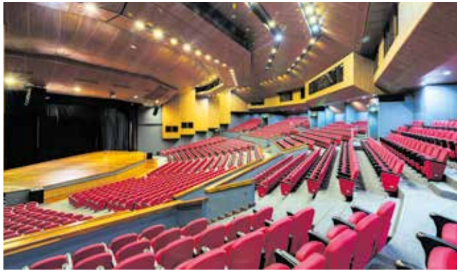
AUDITORIO GETSEMANÍ. Remodelado en su totalidad, se reemplazó el recubrimiento de madera en cielo raso y muros, el sistema de sonido, iluminación, la alfombra y sus 1.462 sillas. Se adquirió un sistema de plataformas horizontales para nivelar la platea inferior. Se renovaron sus camerinos.
